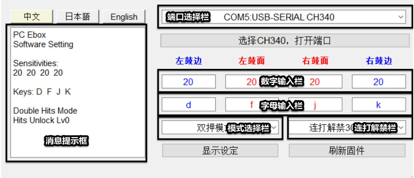
**3. 设定说明:** 打开设定软件, 在**端口选择栏**选择 **CH340**, 如果没有显示, 说明没有安装驱动, 或者没有插 USB 线。点击“**选择 CH340, 打开端口**”, 点击后按钮变为“**关闭端口**”。点击**显示设定**按钮, 如果连接成功, **消息提示框**会刷新。设定完毕后, 点击**刷新固件**按钮, **消息提示框**会刷新。如果与设定一致, 说明刷新成功。
